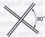
Cruce de conductores
